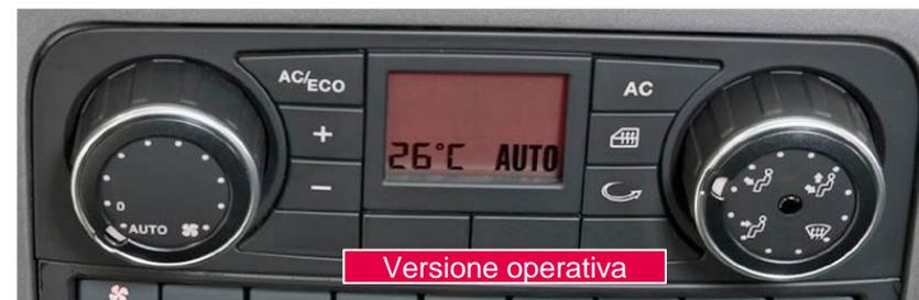
Nuovo display del climatizzatore e nuovi elementi di comando
