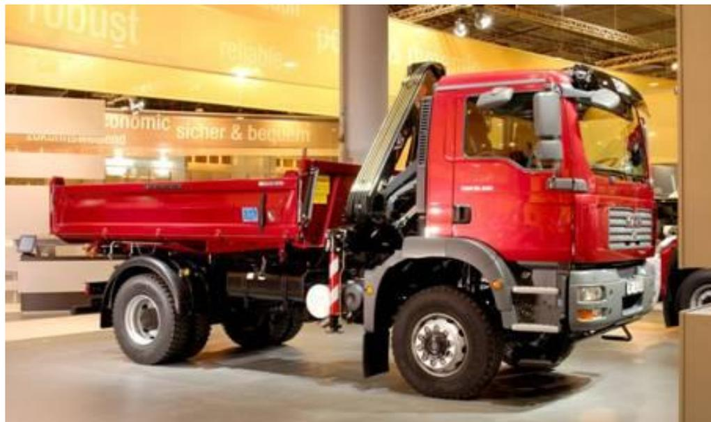
▪ Nel caso siano presenti solo gli stabilizzatori anteriori (2 piedi stabilizzatori), si può valutare anche il 311PH che consente di muoversi durante il ribaltamento, se necessario (solo TGM N36 BL). L'Allestitore dovrà decidere se è compatibile con la stabilità del mezzo (Direttive Allestimento).
